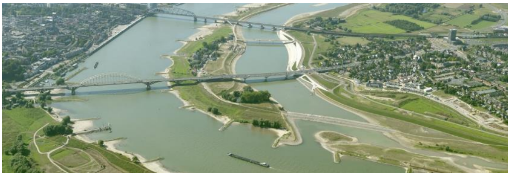
Figuur 1.1: Lent en Nijmegen waar RWS de dijk heeft verplaatst en een geul heeft aangelegd voor betere doorstroming bij hoogwater.
