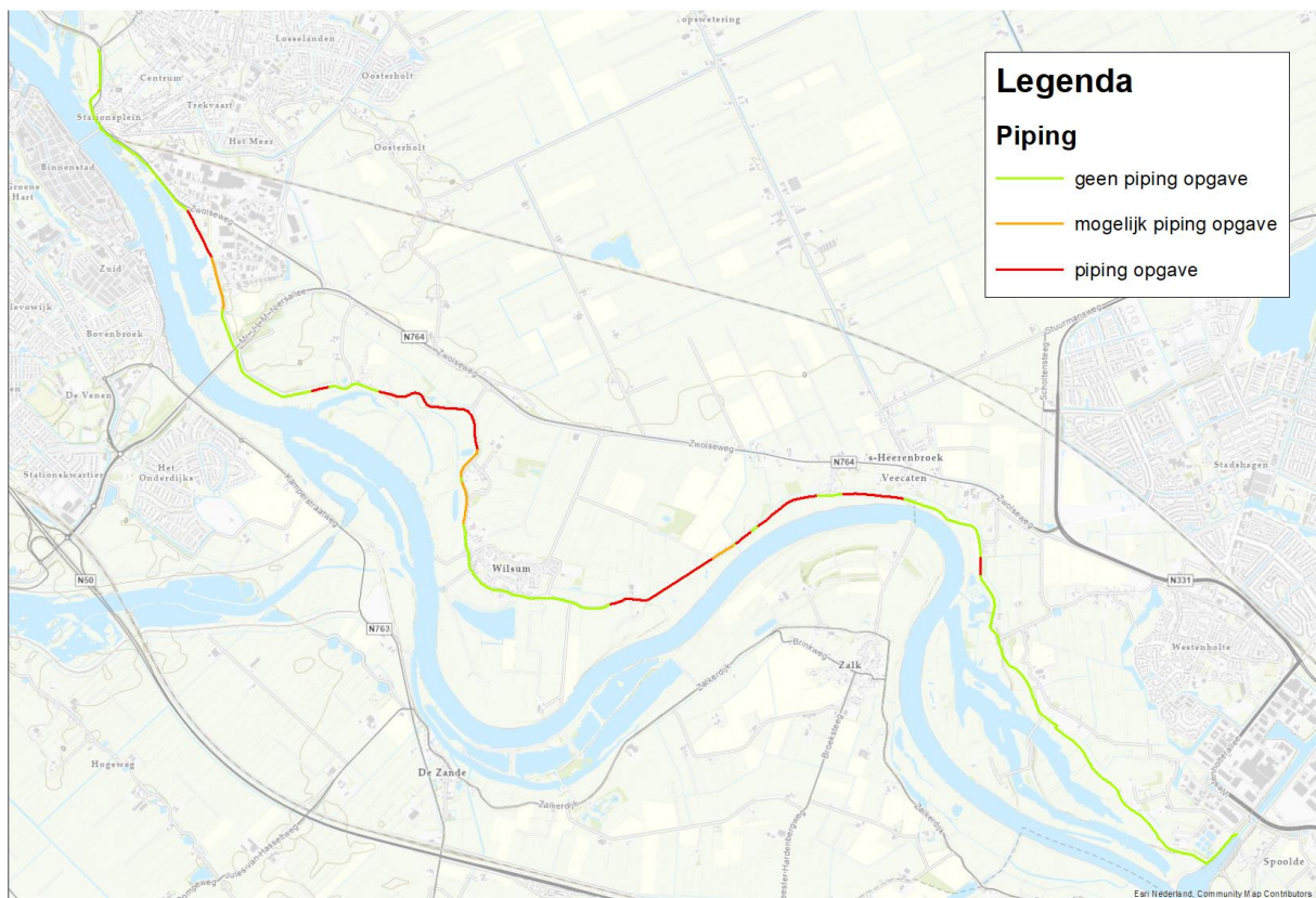
Figuur 2.4: Piping ontwerpogave o.b.v. zichtjaar 2080 (Hydra-NL)
