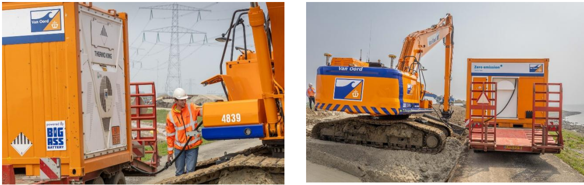
Figuur 22: Eén van de accupakketten (de Big Ass battery) die de elektrische kraan aan het opladen is
