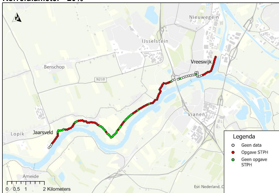
Figuur A 2: Pipingopgave voor een variatie in korreldiameter (+20%)
